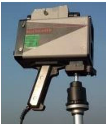
Le Multalaser est le tout premier radar laser, homologué en France en 1995. Il se tient à la main, à la manière d'un pistolet, d'où son surnom de "pistolet-radar". Sa portée peut dépasser les 600 mètres dans des conditions météorologiques idéales, mais en pratique, elle se limite généralement à environ 450 mètres.
